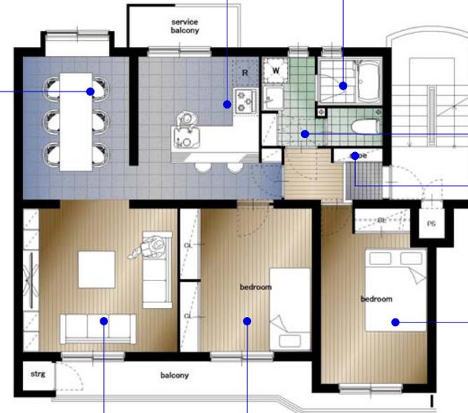
ドアのない洗面室にドアと収納を設置。トイレは洗面室を介したアクセスとする。
