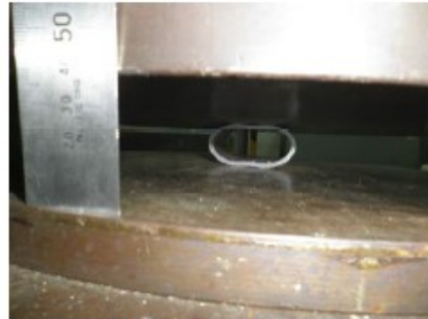
写真5 偏平試験の風景(VP50)
